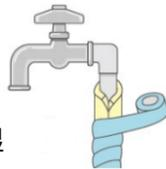
凍結する場所は主に屋外に露出している水道管や蛇口です。そこに布やフェルトなどの保温材料巻き付け、濡れないようにビニールテープでしっかりと巻きまわす。
